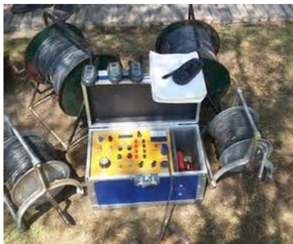
(Fig. 7) Equipo sondeo eléctrico vertical
